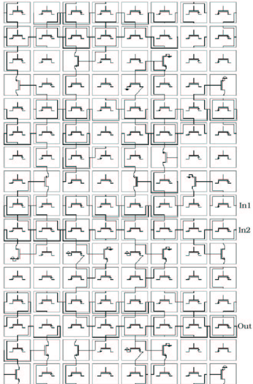
Abbildung 2.12: Beste evolutionierte Schaltung mit Einsatz von Building Blocks.
