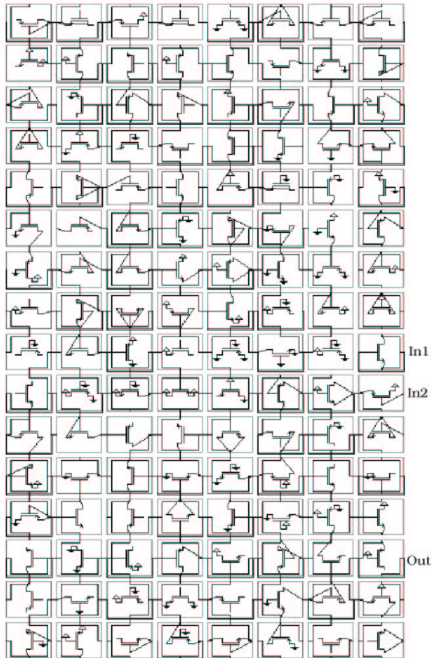
Abbildung 2.13: Beste evolutionierte Schaltung ohne Einsatz von Building Blocks.
